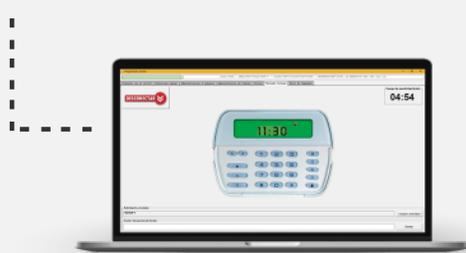
Con **DX VIRTUAL EXPERT**, la empresa de monitoreo tiene una **conexión virtual total con el panel** de alarmas de su abonado, permitiéndole armar, desarmar, reprogramar, etc. Sin tener que asistir a la vivienda en forma presencial.
