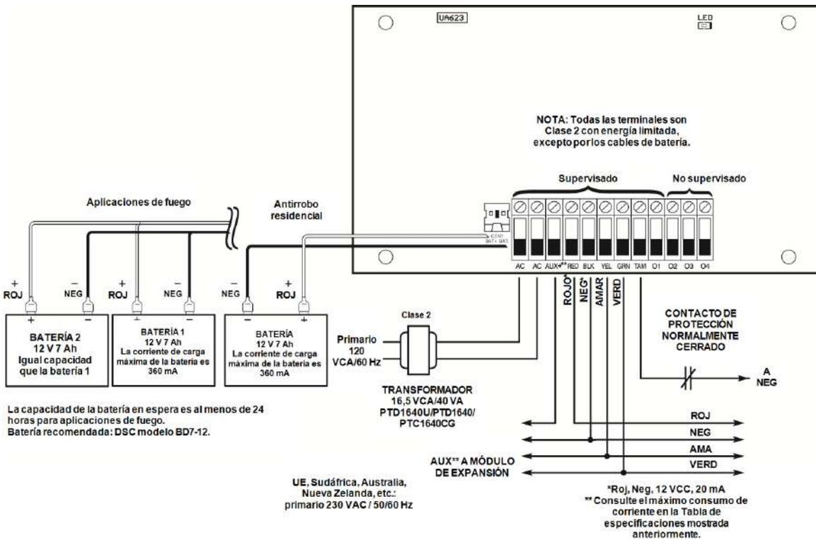
Figura 3-4 Cableado de la fuente de alimentación
