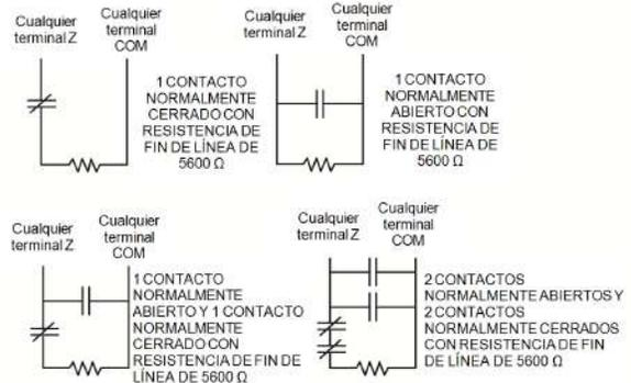
**Cableado de resistencia de fin de línea doble**
