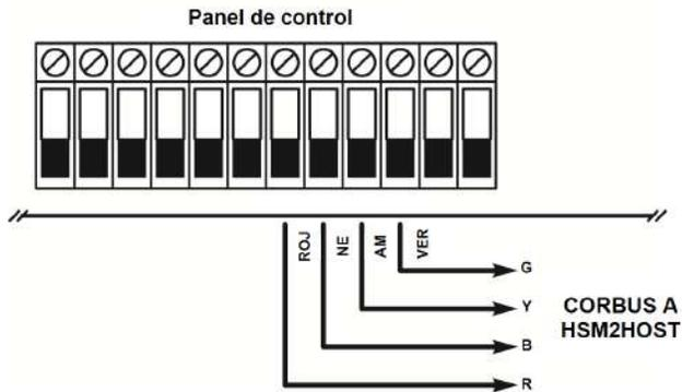
Figura 3-3 Diagrama de cableado del HSM2HOSTx
