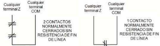
**Cableado de resistencia de fin de línea**
