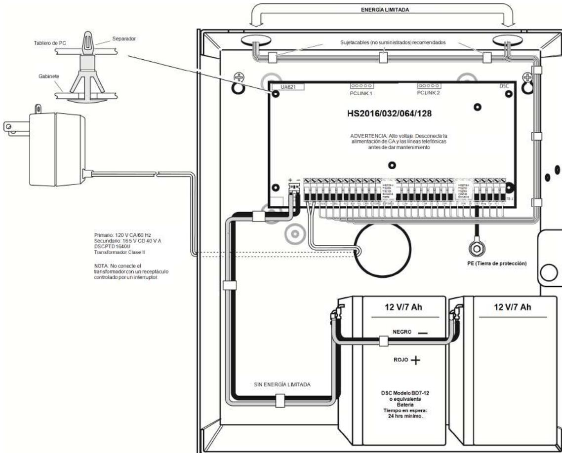
Figura 2-1 Enrutamiento de cableado (América del Norte solamente)
