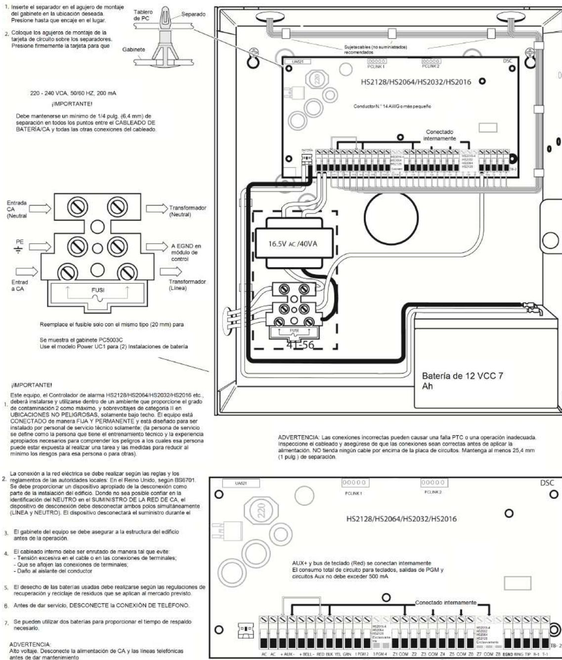
Figura 2-2 Enrutamiento de cableado (exclusivo para EN50131)
