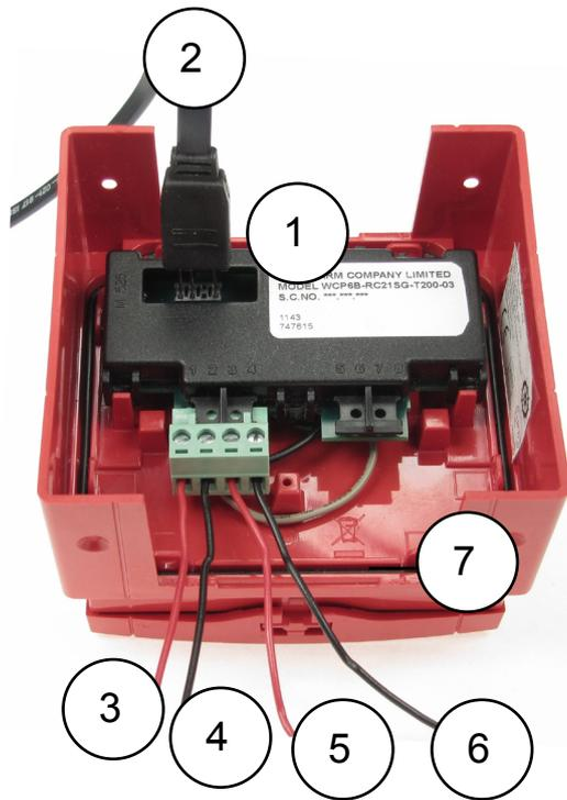
El FC421CP-I está configurado de fábrica con la dirección 255 (no válida). El FC421CP-I ha de ser programado en campo con la dirección antes de la instalación utilizando la herramienta de programación de direcciones de Fireclass. El cable de programación auxiliar asociado se conecta en el puerto de programación.
