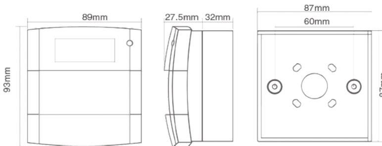
El FC420CP-I se puede montar en una caja posterior (montaje en superficie) que está disponible por separado.
