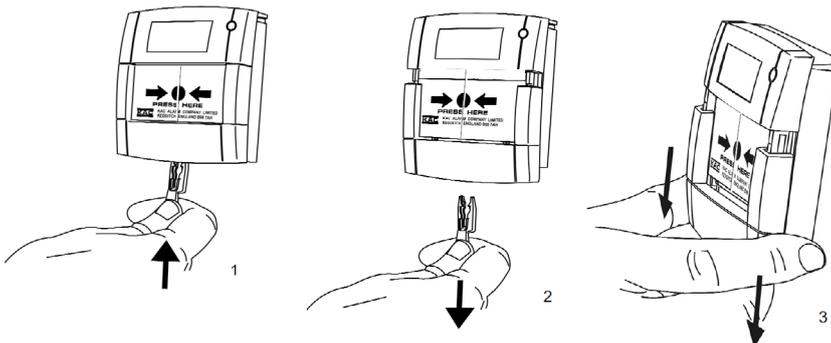
Se suministra una llave de test con cada pulsador manual para permitir un test sencillo del mecanismo de conmutación y del cableado, sin romper el elemento rompible para activación. La llave se inserta en una ranura en la base del pulsador, permitiendo que el elemento rompible caiga lejos del interruptor, activando y registrando una alarma en el ECI.
