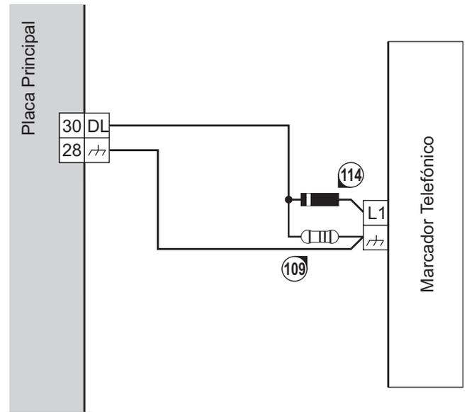
**Figura 21** Conexión de un marcador telefónico: **109**) Resistencia de Fin de Línea de 3900 ohm, 1/4W(naranja-blanco-rojo-oro); **114**) Diodo 1N4007 o equivalente
