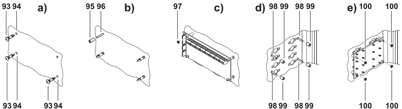
**Figura 10** Instalación de un Kit del Módulo Expansor: 93) Soportes posteriores; 94) Agujeros de anclaje del Módulo Expansor; 95) Separador largo de plástico; 96) Emplazamiento del tornillo del Módulo Expansor; 97) Tuerca del Módulo Expansor; 98) Tornillos de la Tarjeta de Control del Expansor; 99) Separador corto de plástico; 100) Tuerca de la Tarjeta de Control del Expansor.
