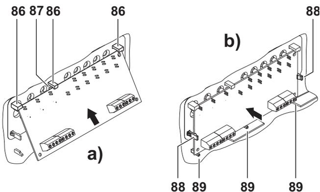
Figura 7 J408: Instalación del Módulo de Extinción
