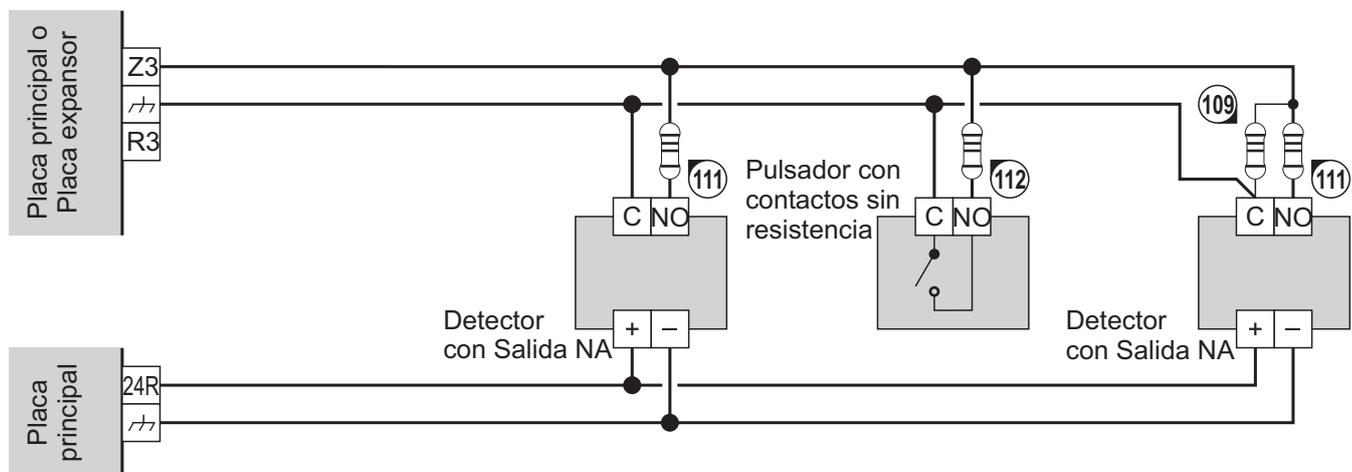
**Figura 15** Conexión de 3 detectores con Salidas Normalmente Abiertas y un Pulsador con contactos sin resistencia: **109**) Resist. Fin de Línea de 3900 ohm, 1/4 W (naranja-blanco-rojo-oro); **111**) Resist. de 680 ohm; **112**) Resist. de 680 ohm (necesaria si la opción **Pulsador Prioritario** está DESHABILITADA) o de 270 ohm si la opción **Pulsador Prioritario** está HABILITADA).
