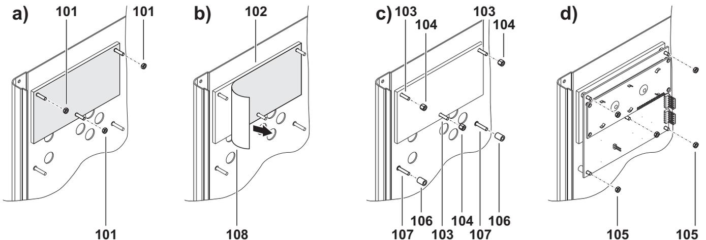
**Figura 12** Instalación del Módulo Display: 101) y 105) tuercas; 102) cristal LCD; 103) y 107) tornillos soldados; 104) Separadores de latón; 106) Separadores de plástico; 108) Película protectora.
