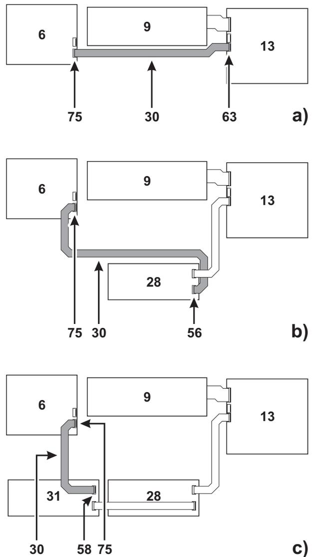
**Figura 13** Conexión del Módulo LCD a la Central: a) sin Módulos de Extinción; b) con UN Módulo de Extinción; c) con DOS Módulos de Extinción ;6) Módulo Display; 9) Placa de Control Principal; 13)Placa Principal; 28) Módulo de Extinción n.º 1; 30) Cable plano para conectar el Módulo Display; 31) Módulo de Extinción n.º 2.
