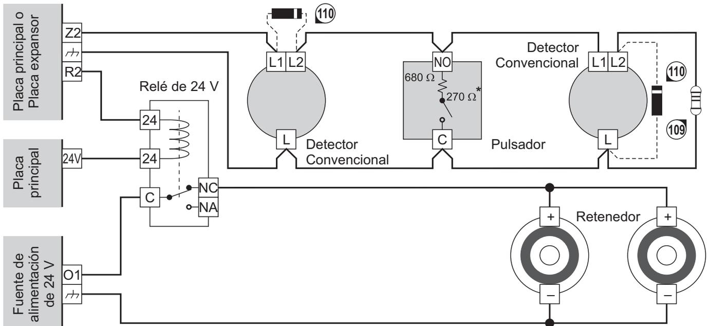
**Figura 14** Conexión de 3 equipos de detección en una zona: **109**) Resist. Fin de Línea de 3900 ohm, 1/4 W (naranja-blanco-rojo-oro); **110**) 1N5819 Diodo (o similar) — necesario si está habilitada la opción **Anular Detectores Perdidos**; \*) Resistencia del contacto del pulsador — necesaria si tiene **Pulsador Prioritario**
